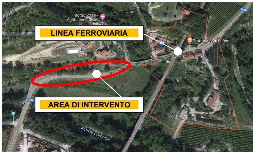
Dai sopralluoghi in sito e dal rilievo topografico di dettaglio risulta evidente che l'attuale tracciato presenta in uscita dal ponte sul Rio Purocielo in direzione Marradi una curva sinistra, poi una curva destra e l'innesto sul ponte Lamone avviene con una curva a raggio molto ridotto.
